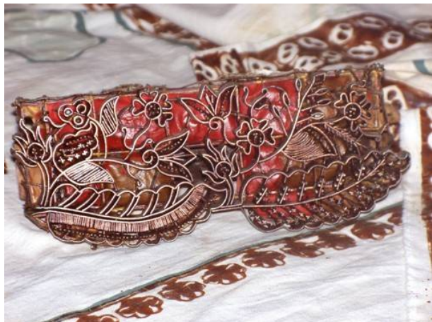
Рис. 13. Медный штамп для нанесения рисунка на ткань горячим воском при изготовлении батика чап (в отличие от батика тулис). Данный штамп – это фрагмент бордюра по краю шарфа или ткани. Фото: Т.А. Тришкина.
