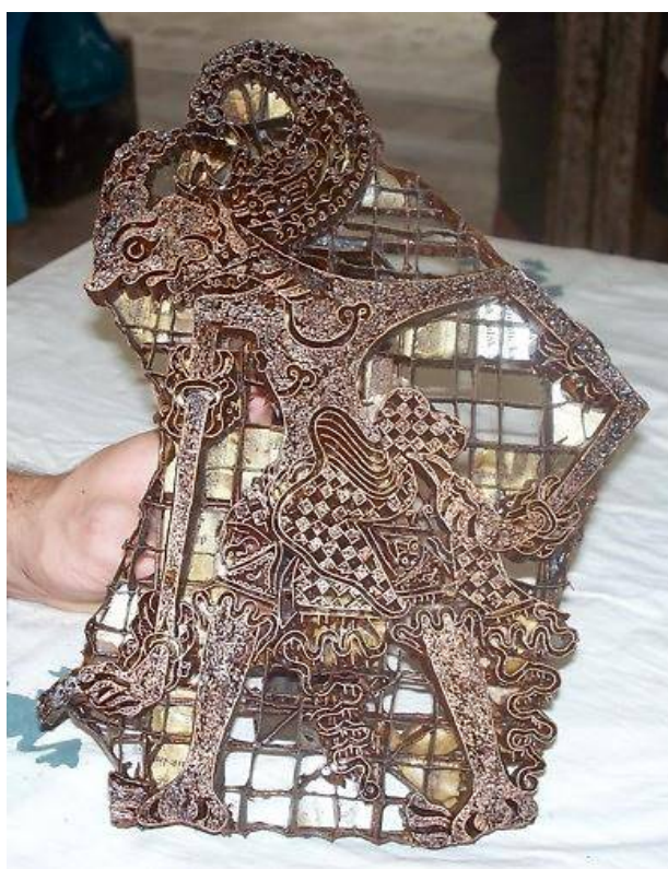
Рис. 15. Медный штамп (чап) для нанесения горячим воском рисунка на ткань при изготовлении батика чап (в отличие от батика тулис). Данный штамп – фигурка героя яванского театра теней Wayang (Ваянг), одного из героев древнего индийского эпоса «Махабхарата». При изготовлении тканей для двора султана часто используют традиционные мотивы индонезийской мифологии. Фото: Т.А. Тришкина.
