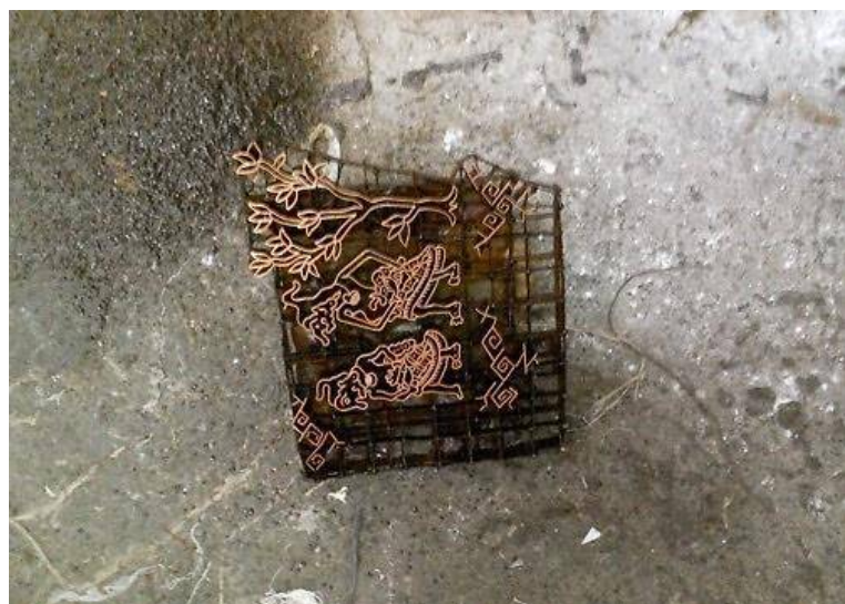
Рис. 6. Чап (штамп), с помощью которого наносят рисунок воском на ткань. Музей батика Danar Hadi в г. Соло на Центральной Яве, мастерские по изготовлению батика. Фото: Т.А. Тришкина.
