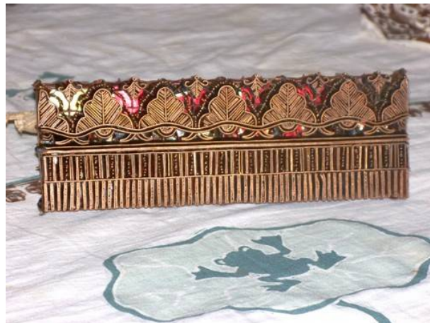
Рис. 14. Медный штамп для нанесения рисунка на ткань горячим воском при изготовлении батика чап (в отличие от батика тулис). Данный штамп – это часть узкого бордюра по краю шарфа или ткани. Фото: Т.А. Тришкина.
